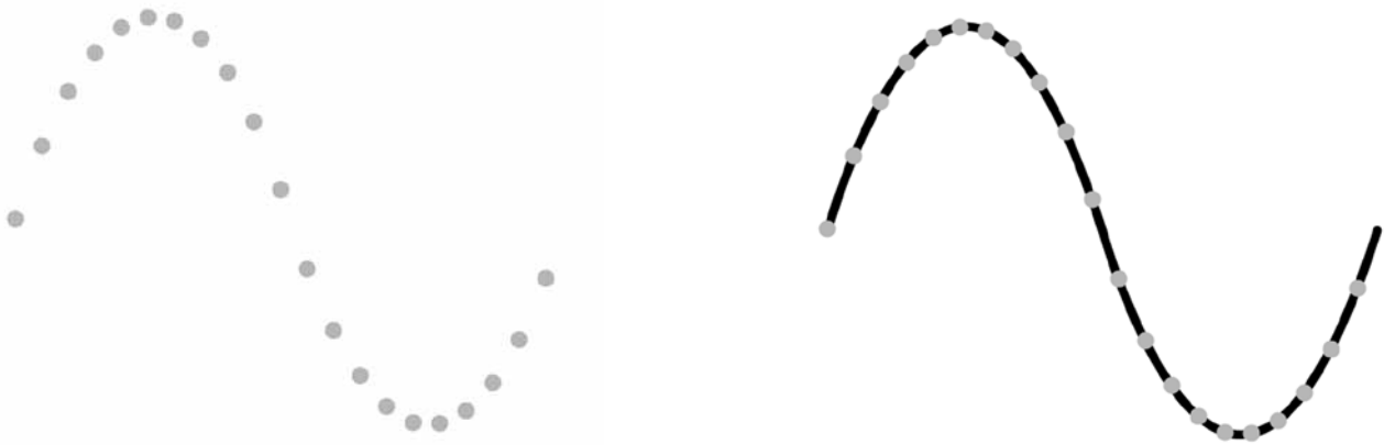
Рис. 17. Серия выборок, представляющих синусоиду (слева); реконструированная синусоида (справа).
