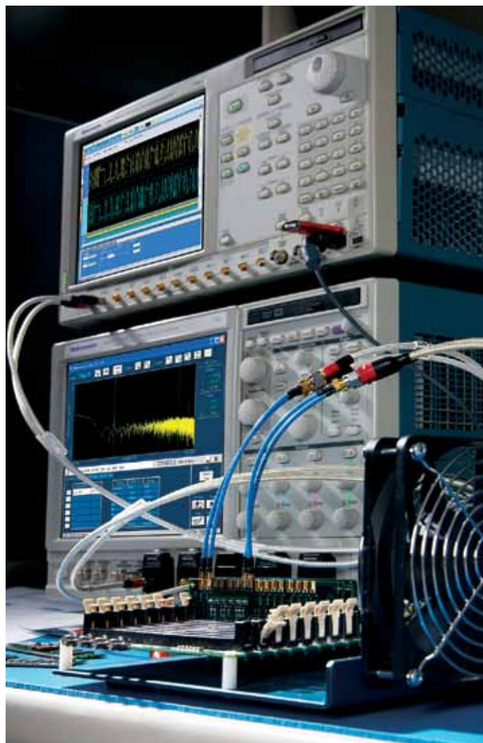
Рис. 1. Для большинства измерений требуется решение, состоящее из генератора сигналов и регистрирующего прибора. Цепь запуска облегчает захват выходного сигнала исследуемого устройства.
