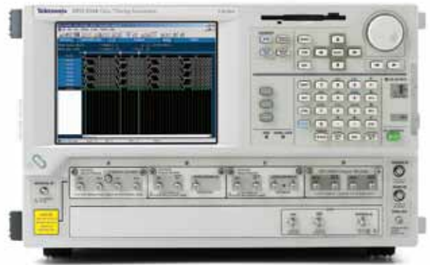
Рис. 48. Высокопроизводительный источник логических сигналов – генератор временных соотношений Tektronix DTG5334.
